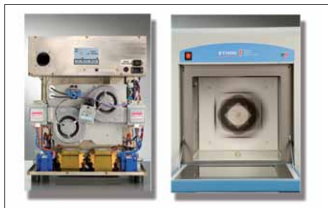
Рис.4. Двухмагнетронная система Milestone Ethos с гомогенизатором излучения
